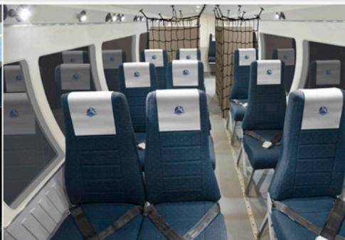
Пассажирский салон при необходимости может быть частично или полностью преобразован в грузовой отсек с ровным полом
